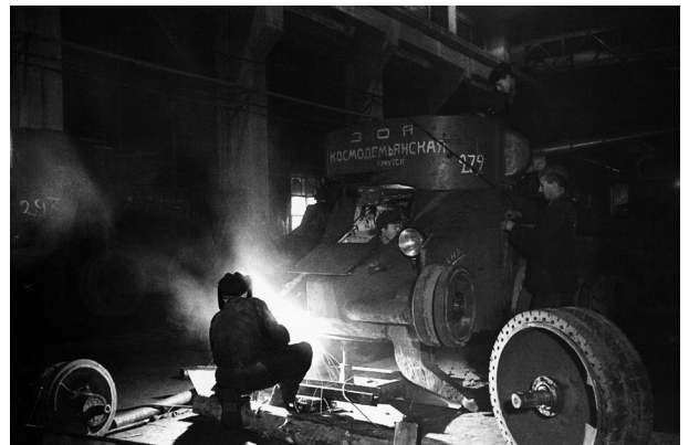
Сборка танка БТ-5 «Зоя Космодемьянская» на иркутском заводе тяжелого машиностроения им. Куйбышева. 1942 год.
